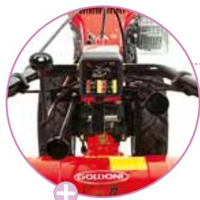
+ Dispositivo di impedimento della retromarcia con la presa di forza inserita nelle operazioni di fresatura.
